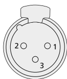
SALIDA DMX Conectores XLR (vista trasera)
